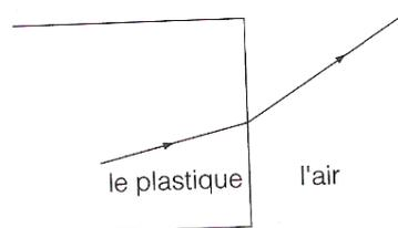
L'angle dans l'air est \_\_\_\_\_ que l'angle dans le plastique. (*plus grand ou plus petit*)
